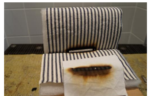
Photo 2 : Test feu TB 117 – 2013 Section 3 matériaux résilients au Laboratoire Feu de FCBA à Champs-sur-Marne (FR 77)
